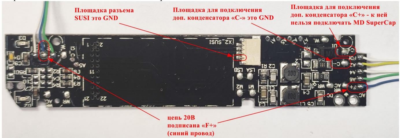
Площадки цепи 20В подписаны «F+» - к ним можно подключить синий провод от MD SuperCap1. Также на плате есть площадки «C+» и «C-» для подключения доп. конденсатора. Площадка «C-» - это GND, к ней можно подключить второй провод от MD SuperCap1. Также GND можно найти на контакте разъема SUSI если он есть на плате модели.
